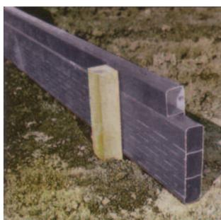
L'**élément superposable FSD** permet de rehausser le profilé de 6 à 7 cm. Cet élément se monte sur le profilé **FSD**. Avant de bétonner, remblayer à hauteur du drain avec le gravier drainant pour contrebuter l'ensemble.
